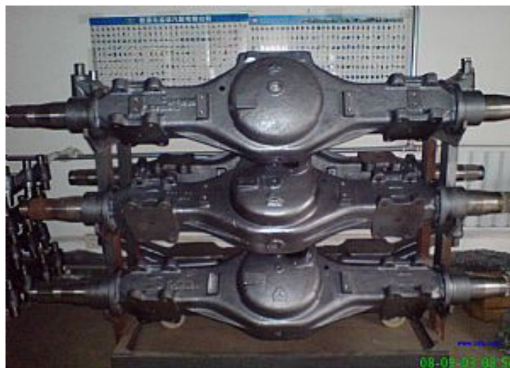
可锻铸铁制造的汽车后桥外壳
